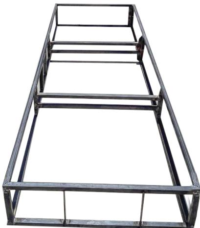
*El uso de tubos de metal para construir una base de estructura metálica en la creación de un tótem publicitario ofrece múltiples beneficios en términos de resistencia, durabilidad y adaptabilidad.*
